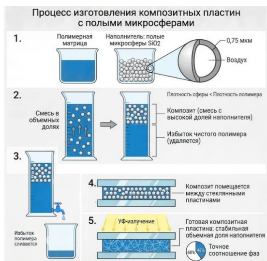
Рисунок 3. Процесс создания образцов композитного материала
