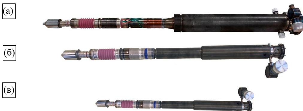
Рисунок 2. Внешний вид двух типов гиротронов нового поколения с КПД генерации до 55%: (а) мощность генерации до 30 кВт, режимы по частоте излучения 28, 35, 45, 95 ГГц, апертура выходного волновода 66 мм, (б) мощность генерации до 15 кВт, режимы по частоте излучения 24, 28 ГГц, апертура выходного волновода 32.6 мм, (в) мощность генерации до 8 кВт, режимы по частоте излучения 14, 18 ГГц, апертура выходного волновода 32.6 мм.
