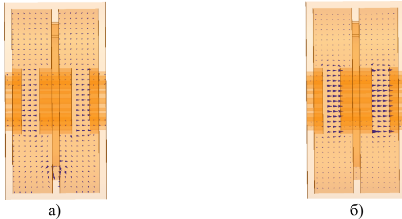
Рисунок 2. Картины поля в исследуемом резонаторе. а- \pi мода; б- 2\pi мода.
