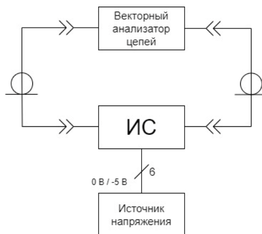
Рисунок 1. Схема измерения S-параметров ИС дискретного аттенюатора.
