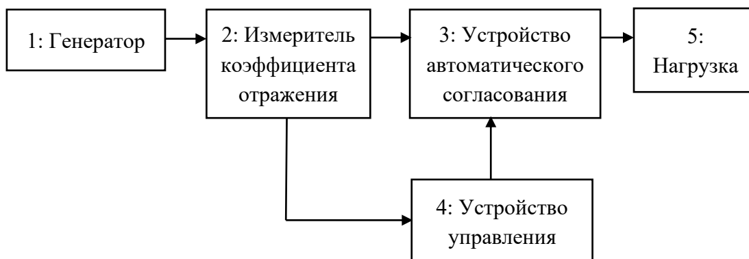
Рисунок 1. Блок-схема высокочастотной экспериментальной установки.
