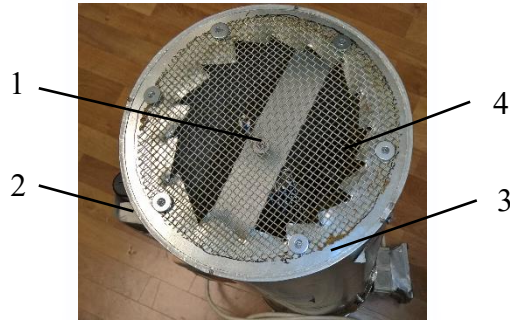
Рисунок 5. Макет согласованной нагрузки для калибровки установки и измерений.
