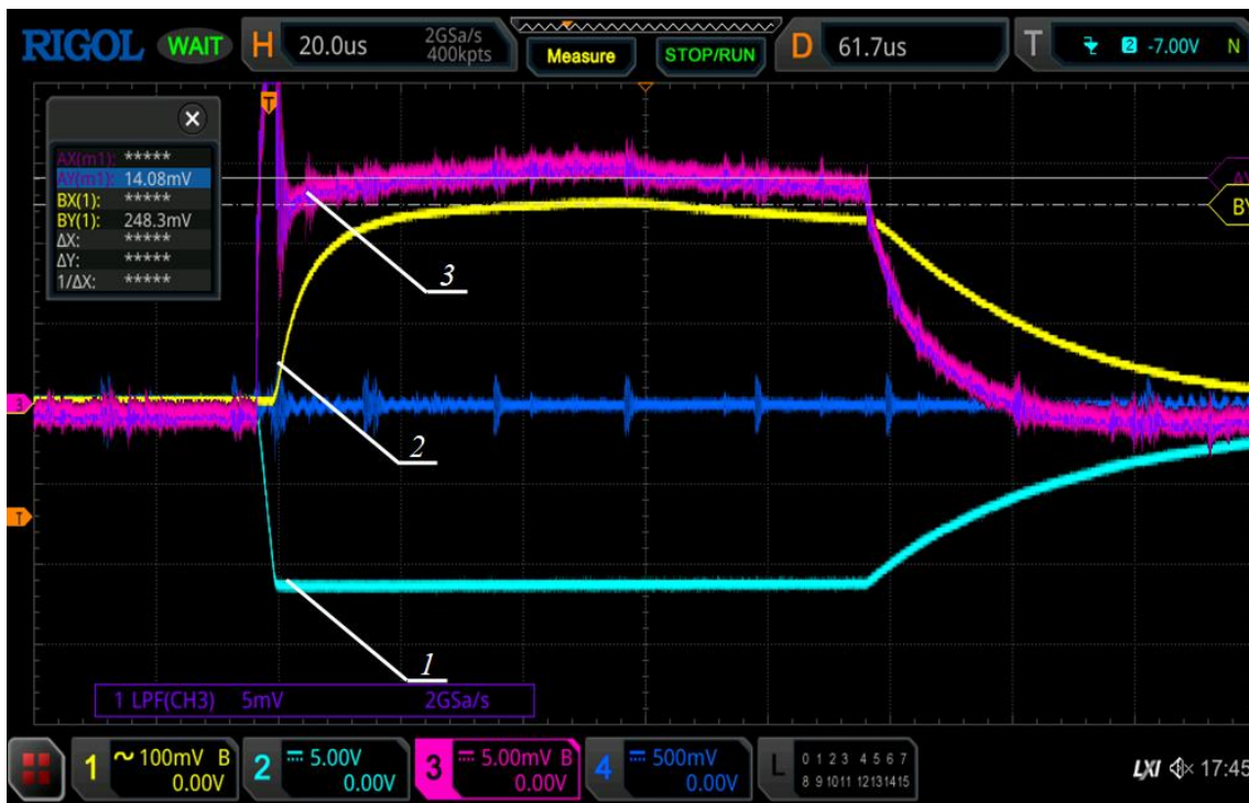
Рисунок 1. Типичная осциллограмма при проведении измерений 1 - импульс отрицательного напряжения на катод; 2 – амплитуда СВЧ поля измеренная диодным детектором; 3 – ток эмиссии с катода.
