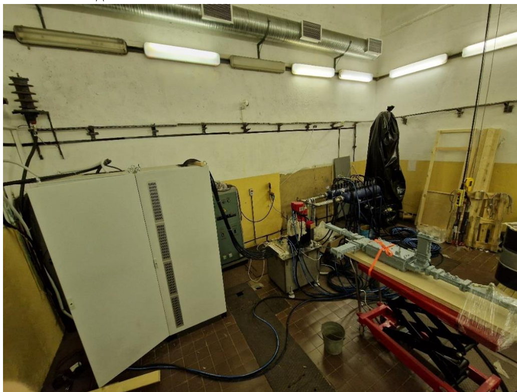
Рис. 2. СДИ прибора КИУ-287, включающий в себя модулятор, соленоид фокусирующей системы, выходной СВЧ-тракт и систему охлаждения
