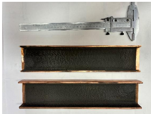
Рис.4. Половинчатые элементы волновода с керамикой.
