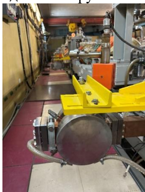
Рис.1 Внешний вид СВЧ нагрузки на ЛУ ВЭПП-5 и СКИФ.
