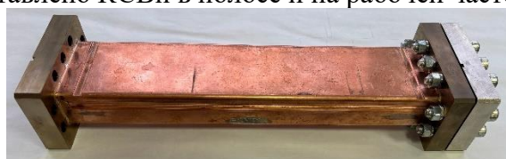
Рис.5 Сварная конструкция нагрузки.
