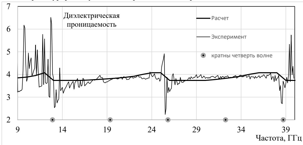
Рисунок 1 Расчетная и измеренная частотные зависимости диэлектрической проницаемости пластины из кварцевого стекла, полученные из анализа угловых зависимостей вблизи угла Брюстера.
