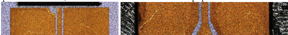
Рисунок 2. Дефекты контактной фотолитографии (выбоины, несимметричность зазоров \pm 4 мкм, несоответствие размеров \pm 7 мкм).
