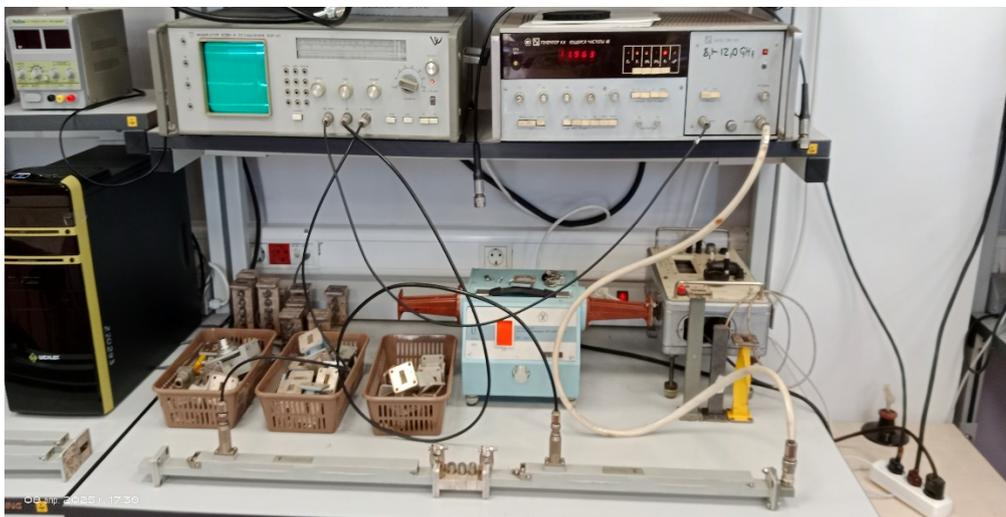
**Рисунок 2.** Общий вид стенда при измерении АЧХ фильтра.
