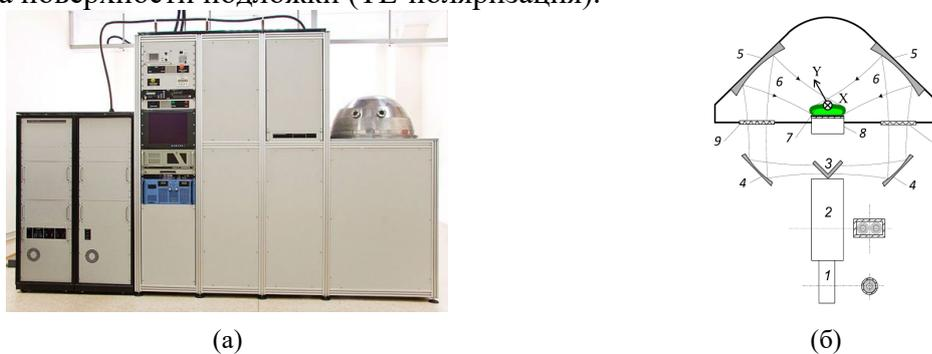
**Рисунок 3.** а) Общий вид CVD реактора для синтеза алмаза на основе гиротрона. б) Схема плазменного реактора с двумя пересекающимися волновыми пучками: 1 – круглый волновод, 2 – волновой делитель, 3 – плоские зеркала, 4 – нижние фокусирующие зеркала, 5 – верхние фокусирующие зеркала, 6 – волновые пучки, 7 – газоразрядная плазма, 8 – держатель подложки, 9 – вакуумные окна для ввода микроволнового излучения в разрядную камеру.
