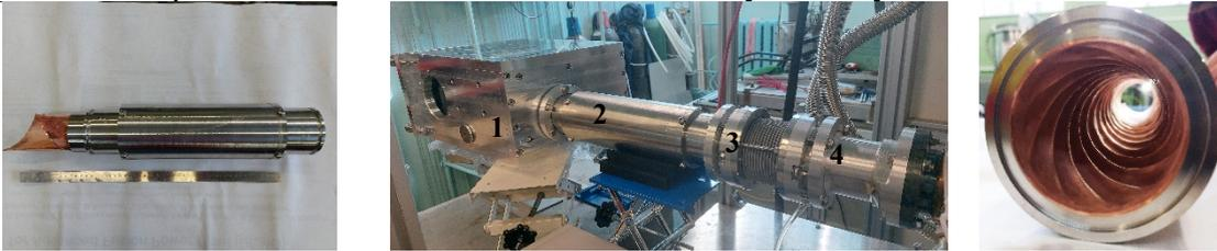
**Рисунок 2.** Линия передачи в сборе и отдельно преобразователь: 1 – МОУ, 2 – преобразователь, 3 – компенсатор, 4 – переход.
