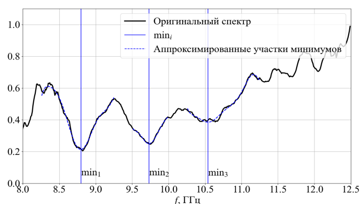
Рисунок 4. Нахождение локальных минимумов отражения спектра, аппроксимированного полиномом, при концентрации соли 13,7 г/л.
