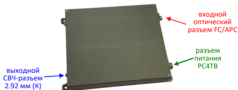
Рисунок 3 Фотография СВЧ-фотодиодного модуля с оптическим усилителем на легированном эрбием волокне
