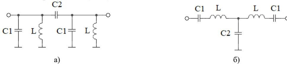
**Рисунок 2.** Схемы LC-фильтров а)- на параллельных контурах, б)- на последовательных контурах.
