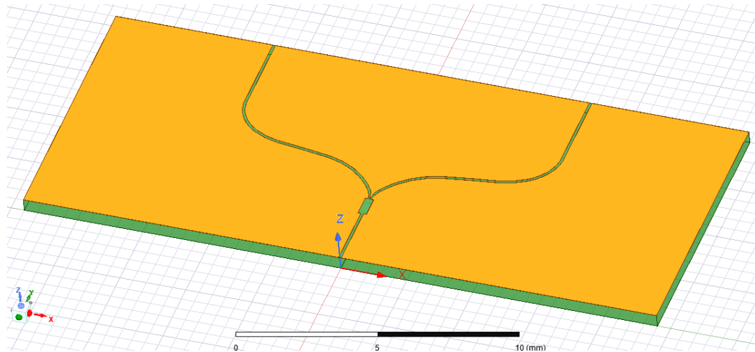
Рисунок 4. Модель Y-образного делителя с плавными поворотами щели.
