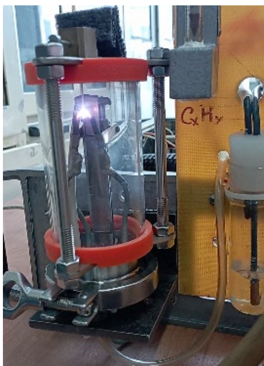
Рисунок 3. Процесс формирования пиролитического углеродного покрытия на диэлектрическом стержне с помощью плазменного разряда.
