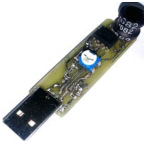
Рисунок 2. Миниатюрная версия электрической цепи Чуа в форм-факторе USB flash driver.
