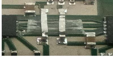
**Рисунок 7.** Установленные между печатной платой и перемычками экспериментального макета диэлектрические вставки.
