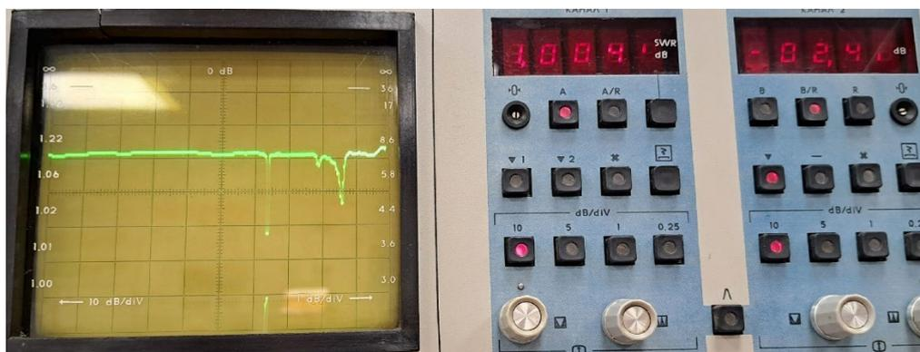
**Рисунок 2.** Максимальное ослабления сигнала для 1 пластины толщиной 1 мм
