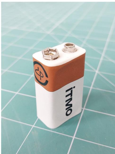
**Рисунок 4.** Изготовленный прототип модуля с функцией беспроводной зарядки стандарта Qi.
