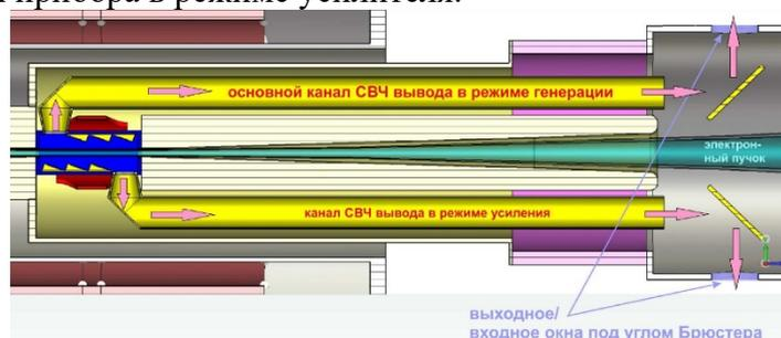
Рисунок 2. Электродинамическая система квазиоптической зигзагообразной giro-ЛОВ.
