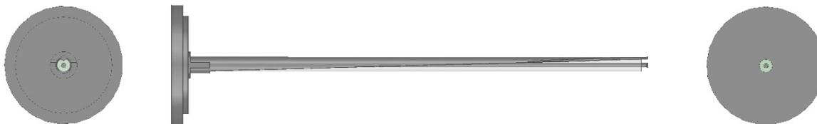
**Рисунок 2.** Кососрезанное согласующее и симметрирующее устройство, используемое для возбуждения спиральной излучающей структуры во втором варианте.
