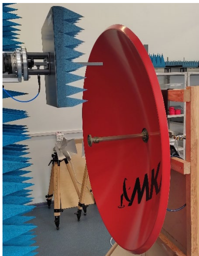
Рисунок 4. Макет антенной системы на измерительном стенде
