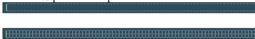
Рисунок 5. Двумерные 152-портовые модели отрезка микрополосковой линии: сверху – один сегмент с выводами только по периметру; снизу – составленный из множества однотипных сегментов (+223 внутренних вывода).
