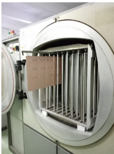
Рисунок 1. Заготовка с образцами перед её помещением в рабочую камеру «Terpla 3027-E»
