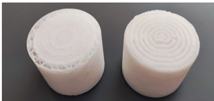
Линзы из неоднородного искусственного диэлектрика, произведенные на кафедре ТОР СПбГЭТУ «ЛЭТИ»
