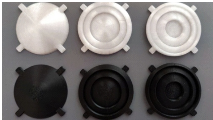
Замедляющие линзы изготовлены с использованием аддитивных технологий на кафедре ТОР СПбГЭТУ «ЛЭТИ»
