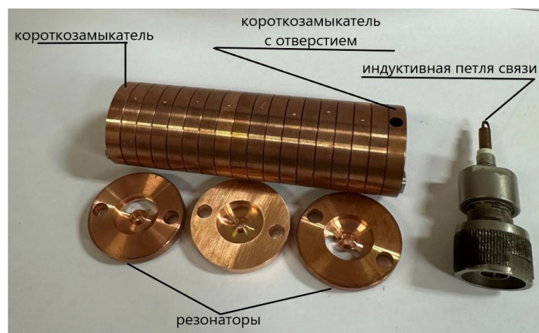
Рисунок 5. Макет ЗС, для «холодных» измерений электродинамических характеристик, в сборе.
