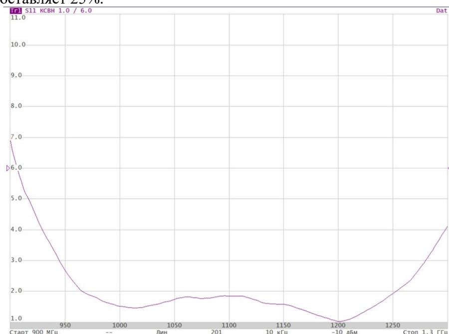
**Рисунок 6.** График КСВн экспериментального образца в полосе частот
