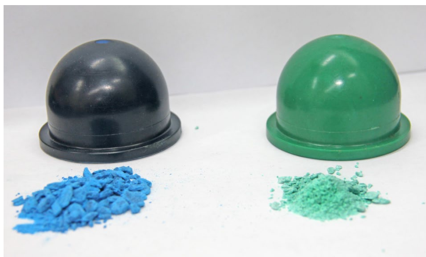
Рисунок 1. Заготовки для корпусов спиральных антенн из эпоксидных прессовочных материалов производителей АО «НПО «Стеклопластик» (слева) и ПАО «Уралхимпласт» (справа) без наполнителей.
