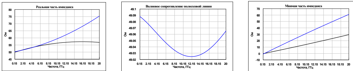
Рисунок 4. Частотные зависимости волнового сопротивления, реальных (слева) и мнимых (справа) значений импеданса 3D-модели резистора P1-160 50 Ом для монтажа в разрыве экранированной копланарной линии стандартным способом (линии синего цвета) и способом «перевернутого кристалла» (линии черного цвета).
