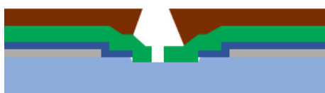
Рисунок 4. Третий этап - формирование шляпки затвора в электронном резисте
