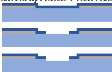
Рисунок 2. Первый этап – это формирование канала транзистора
