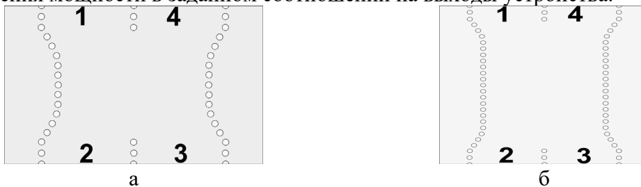
Рисунок 2. а - внешний вид направленного ответвителя, б - внешний вид кроссовера
