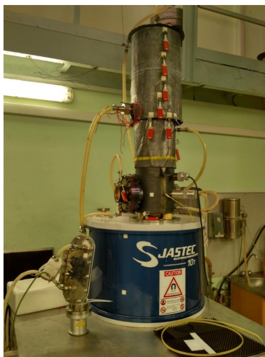
Рисунок 1. Общий вид гиротрона с рабочей частотой 250 ГГц, установленного в криомагните.
