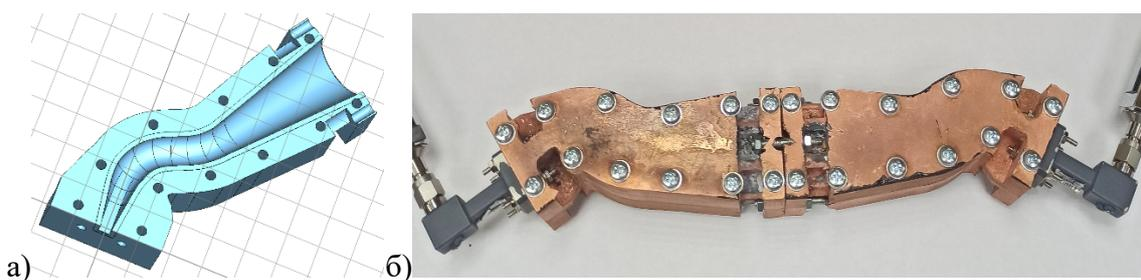
**Рисунок 5.** а) модель половины преобразователя в моду  $E_{01}$  для 3D-печати; б) собранные для измерений преобразователи.
