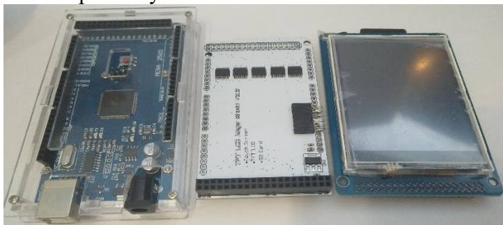
Рисунок 1. Слева направо: Arduino Mega, плата расширения TFT LCD Mega Shield V2.2, TFT_320QVT_9341
