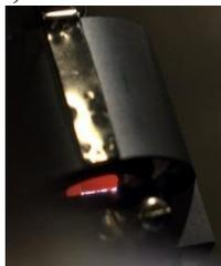
**Рисунок 3.** Свечение анода в результате нагрева автоэмиссионным током с катода в течение 30 мин мощностью 15,3 Вт (1,8 кВ, 8,5 мА)
