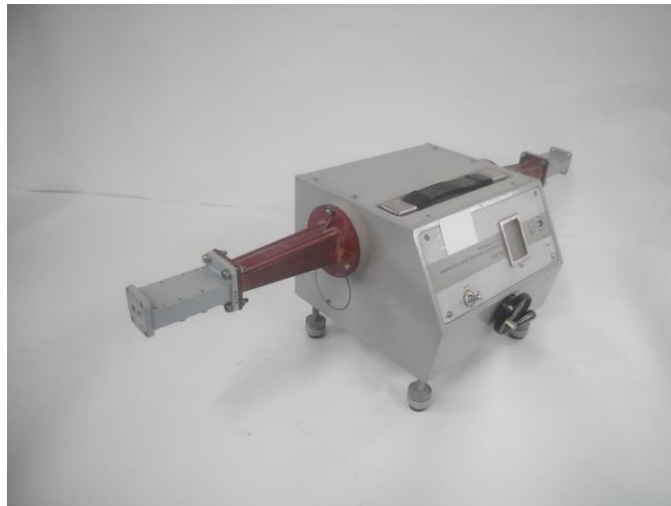
Рисунок 2. Внешний вид аттенюатора Д33-34 с установленными переходами
