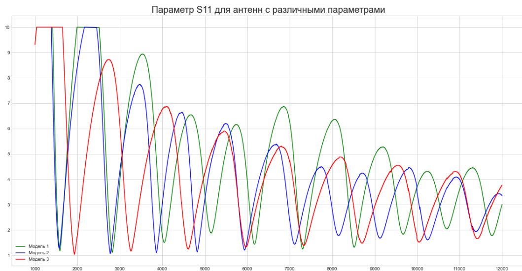
Рисунок 1. Зависимость коэффициента стоячей волны от частоты для древовидных антенн с разными геометрическими параметрами. Модель 1 – целиком изготовлен из медной проволоки диаметром 1 мм. Длина ствола – 103 мм (с учётом разъёма измерительного стенда). Длина каждого из плечей – 30 мм. Модель 2 – Ствол из латунной трубки, диаметром 2 мм и длиной 100 мм (с учётом разъёма измерительного стенда). Плечи из медной проволоки, диаметром 1 мм. Угол между плечами 82 градуса. Модель 3 - медная антенна длиной ствола 100 мм и диаметром 2 мм. Длина плечей – 20 мм, диаметр сечения плечей – 1 мм. Угол между плечами – 60 градусов.
