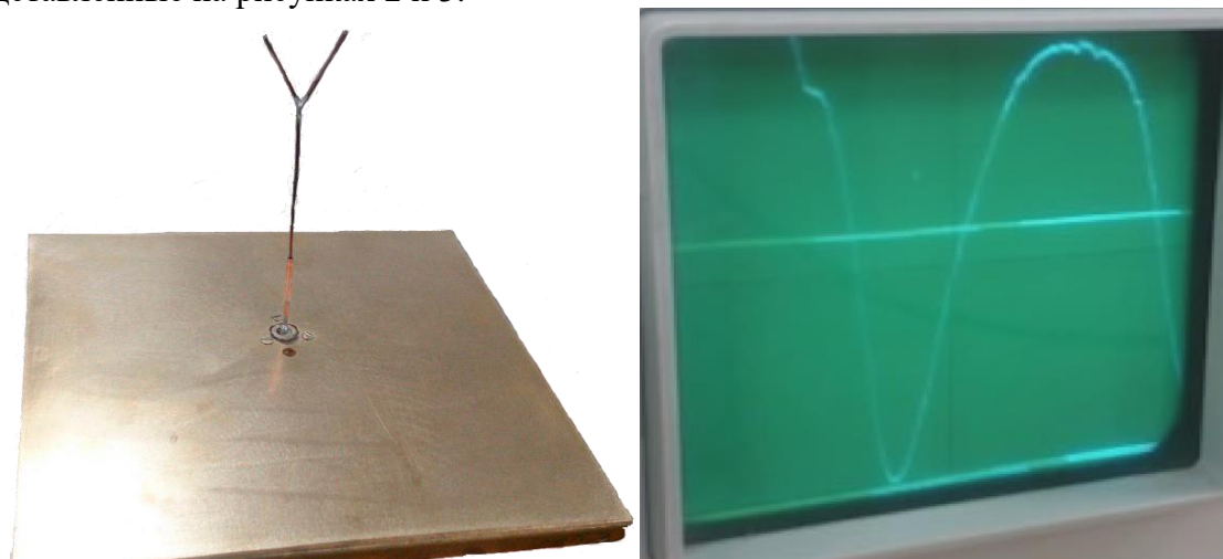
Рисунок 2. Макет 1 и КСВ, полученный в результате измерений макета 1 на частоте 2 – 4 ГГц.
