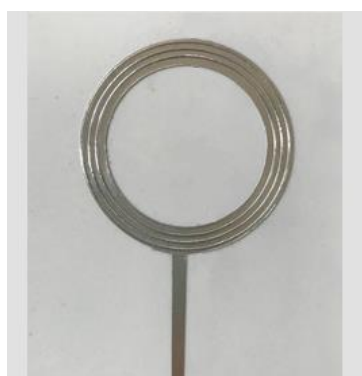
Рисунок 9. Макет излучателя с щелями на верхней стороне.
