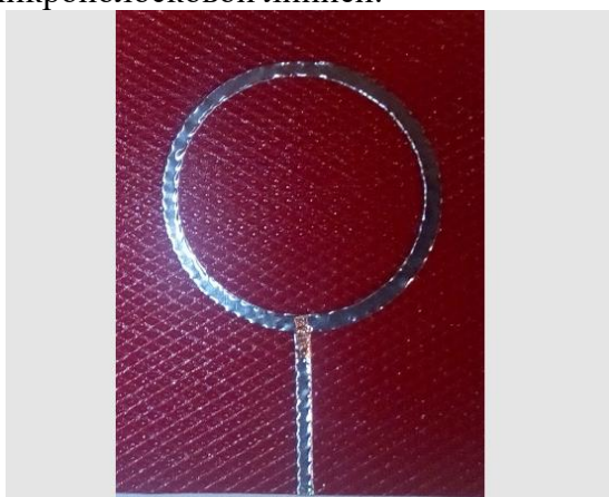
Рисунок 4.1. Излучатель на основе кольцевого резонатора с использованием подложки из гофрированного полистирола.
