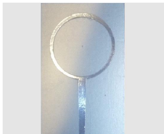
Рисунок 4.2. Излучатель на основе кольцевого резонатора с использованием подложки из технического пропилена.
