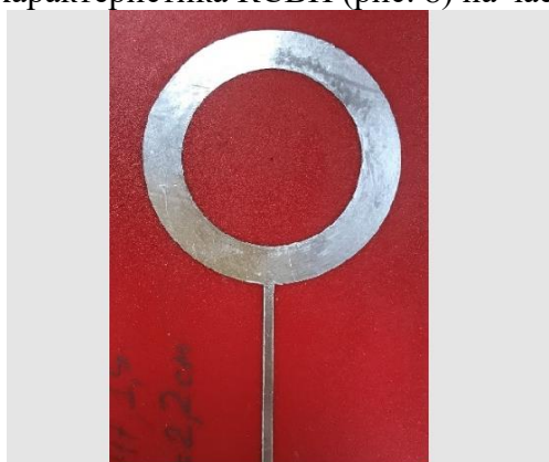
Рисунок 7. Кольцевой резонатор в качестве излучателя с подложкой из полиуретана.
