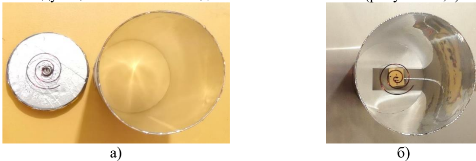
Рисунок 2. Сборочные макеты №1 и №2, с различными способами питания возбуждающего элемента волновода. (а - коаксиальное питание, б - питание через МПЛ)
