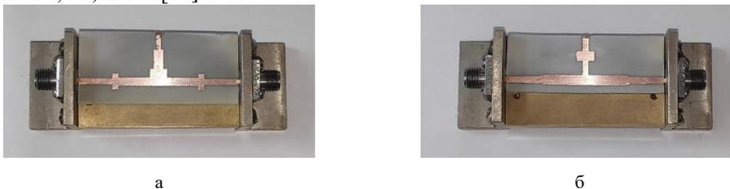
Рисунок 3. Фазосдвигающие каналы первого (а) и второго (б) типа в измерительной оснастке.
