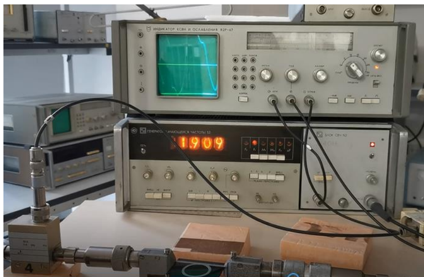
Рисунок 2. Установка, на которой проводилось исследование кольцевого резонатора на феррите
