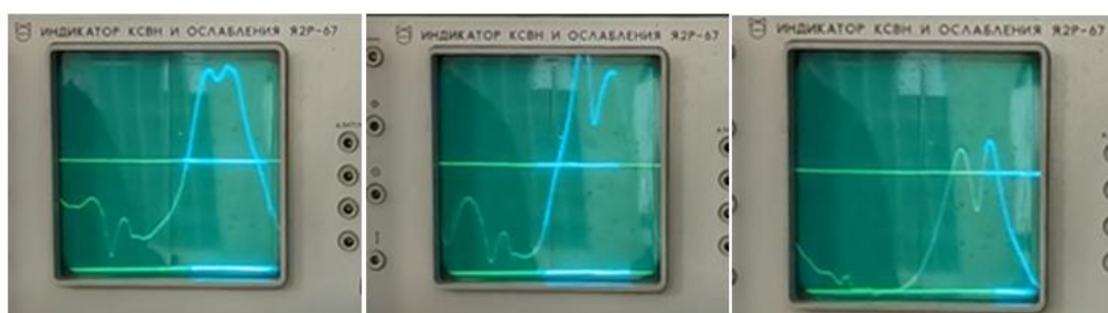
Рисунок 3. Изменения АЧХ кольцевого резонатора на феррите под действием магнитного поля
