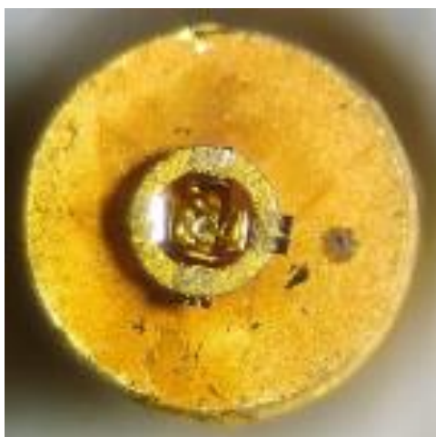
Рисунок 3. Кристаллодержатель с алмазным теплоотводом и диэлектрической втулкой из поликристаллического CVD-алмаза с установленным и разваренным ЛПД.
