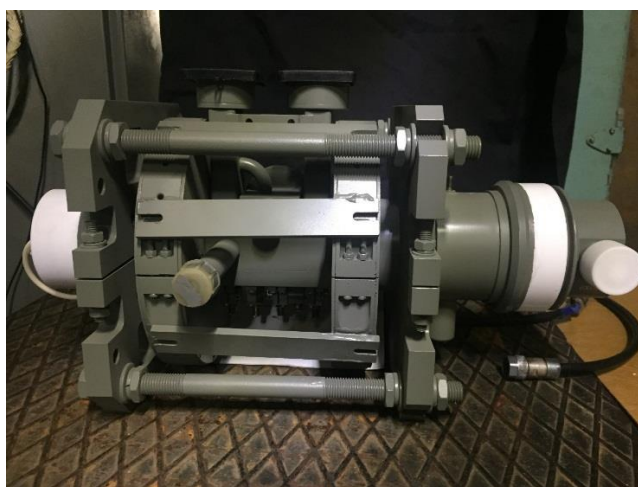
Рисунок 1. Внешний вид непрерывного широкополосного клистрона С-диапазона КУ-409, разработанного в АО «НПП «Торий»
