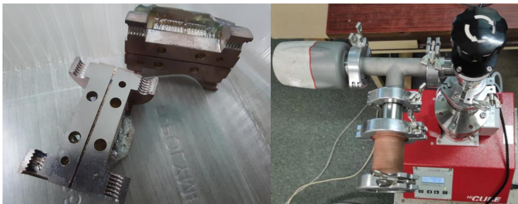
Рисунок 1. Пример СВЧ-компонентов из омеднённого химическим путем фотополимера: высокочастотный волновод (поперечный размер канавки 0.5x0.5 мм) – слева; испытание на вакуумную стойкость цилиндра с фланцами KF40 – справа.
