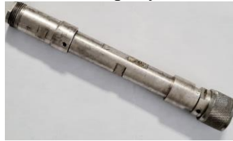
Рисунок 3. Фильтр нижних частот Чебышева
