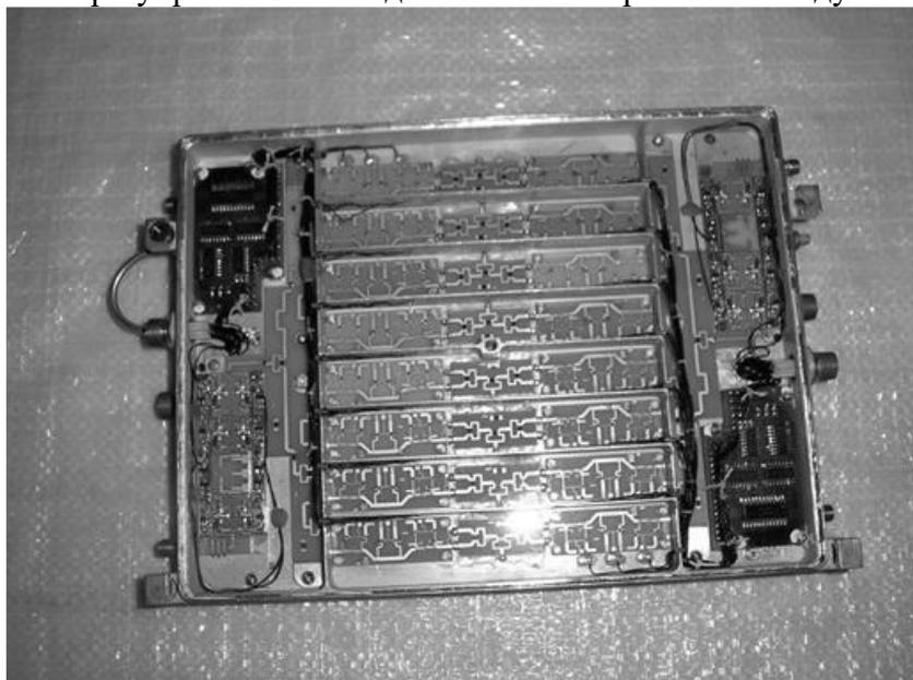
Рисунок 3. Приемный модуль С-диапазона
