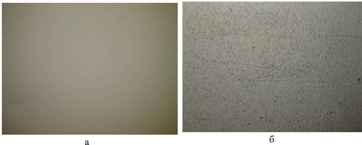
Рисунок 1. Фотографии фоторезиста AZ4562 до (а) и после 12 мин. плазмохимического травления (б) в режиме, указанном в таблице 2.
