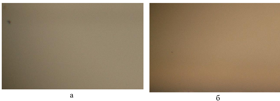
Рисунок 2. Фотографии фоторезиста ФП 25 до (а) и после 12 мин. плазмохимического травления(б) в режиме, указанном в таблице 1.
