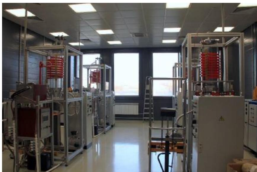
**Рисунок 2.** Установки объемного роста монокристаллов карбида кремния
